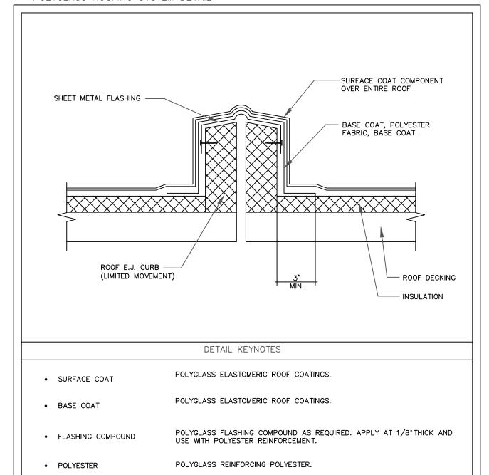
EXPANSION JOINT FLASHING DETAIL
